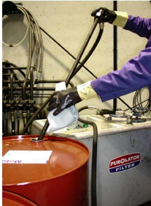
**Bild 5:** Persönliche Schutzausrüstungen beim Ölwechsel
