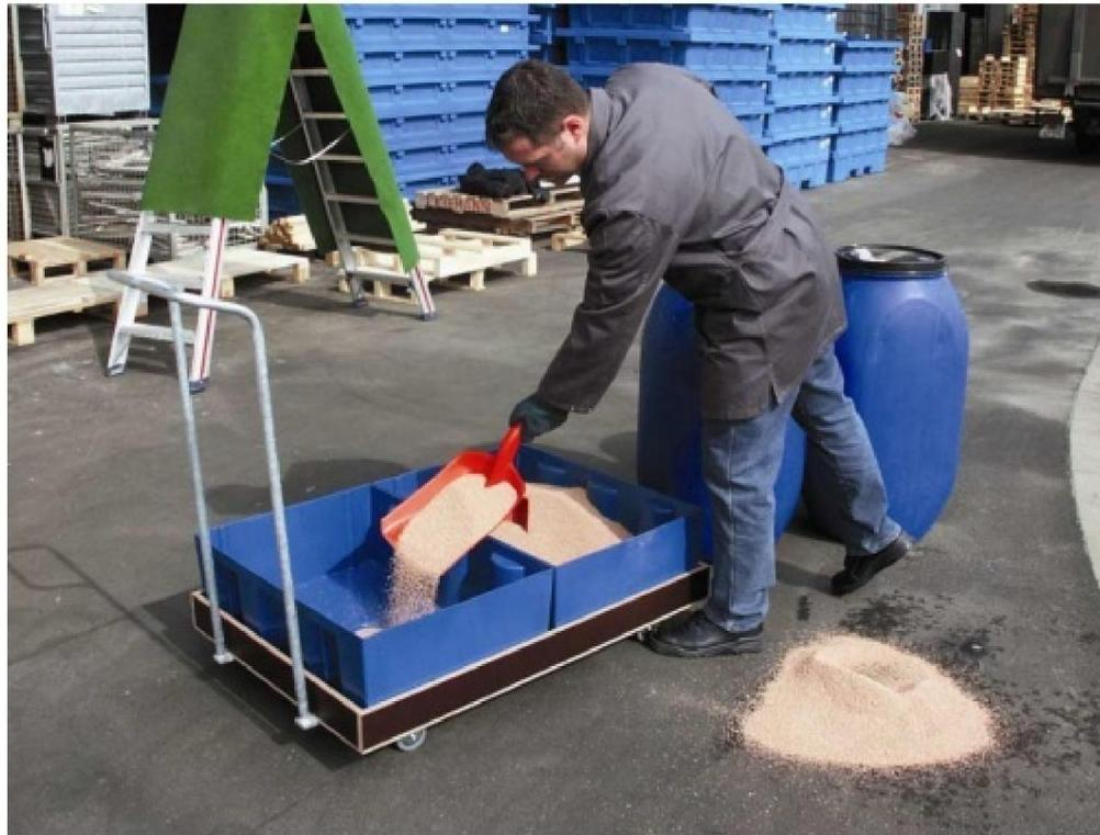
**Bild 7:** Handwagen zum Transport von Ölbindemittel
