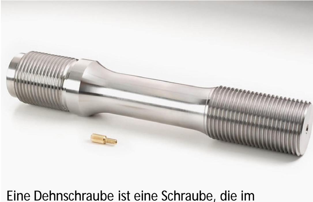
Eine Dehnschraube ist eine Schraube, die im Betrieb auftretende, zeitlich wechselnde Kraft- und Längenänderungen durch elastische Dehnung ihres Schafts aufnehmen kann.
